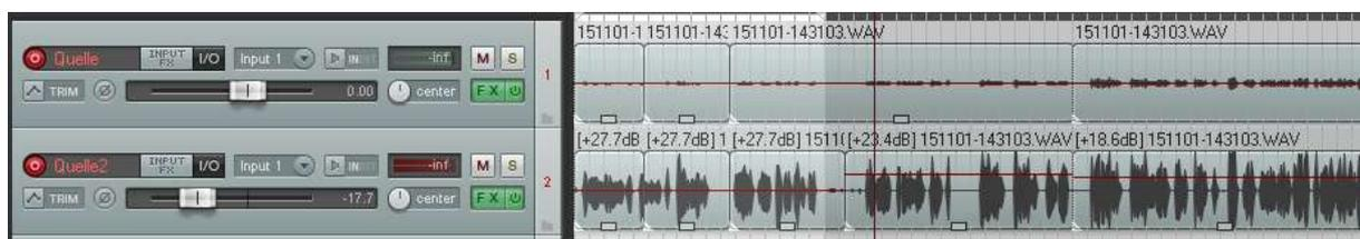
Jede Spur muß vier Audiokanäle enthalten, falls der Reverb Send für die Hallmischung genutzt werden soll. Die Spuren werden jeweils mit einer eigenen Instanz des Emitter Fader versehen, und die Verbindungen zum Effekt werden, wie rechtsstehend gezeigt, hergestellt.
